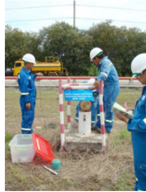
ภาพที่ 2: การเก็บตัวอย่างสารอินทรีย์ระเหยในน้ำใต้ดิน โดยถุงเก็บตัวอย่างแบบแพร่ผ่าน (Diffusion Sampler)
