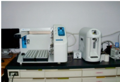
ภาพที่ 3: เครื่องแยกสารประกอบแบบก๊าซ (Gas Chromatography) ต่อพ่วงกับสเปกโตรมิเตอร์มวล (Mass Spectrometry)
