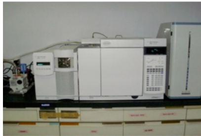
ภาพที่ 3: เครื่องแยกสารประกอบแบบก๊าซ (Gas Chromatography) ต่อพ่วงกับสเปกโตรมิเตอร์มวล (Mass Spectrometry)
