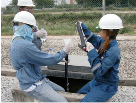
ภาพที่ 2: การเก็บตัวอย่างสารอินทรีย์ระเหยในน้ำใต้ดิน โดยถุงเก็บตัวอย่างแบบแพร่ผ่าน (Diffusion Sampler)
