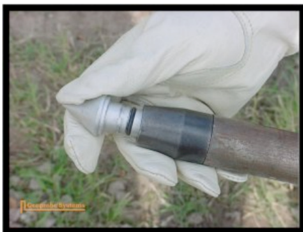
ภาพที่ 7: อุปกรณ์สำหรับติดตั้งโครงข่ายตรวจสอบไอดินเพื่อตรวจวัดปริมาณสารอินทรีย์ระเหยในดินก่อนและหลังการฟื้นฟูด้วยการสกัดไอดิน
