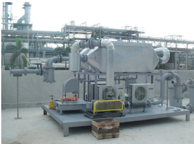
ภาพที่ 8: เครื่องสกัดไอน้ำดิน (Soil Vapor Extraction) เครื่องแรกของประเทศไทย
